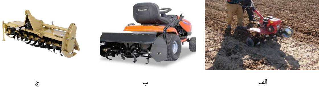
شکل ۱۰- روتیواتور الف- تیلری، ب- باغی و ج- پشت ترکتوری زراعی
