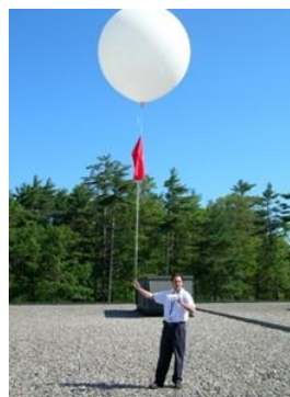
بالن هواشناسی مجهز به رادیوسوند
