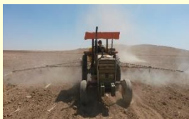
استفاده از سمپاش پشت تراکتوری بومدار
