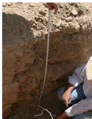
شکل 11- تعیین عمق تراکم ریشه‌های ریز در پروفیل خاک
