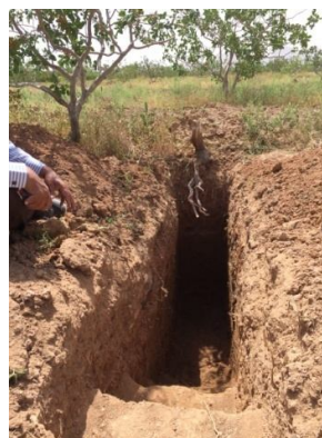
شکل 10- پروفیل حفر شده در سایه‌انداز درختان پسته جهت شناسایی خاک
