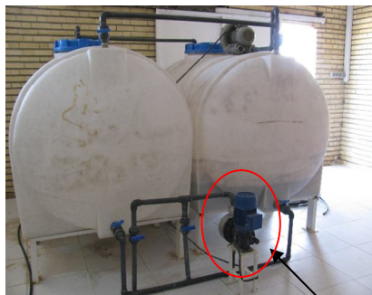
شکل 44- مخزن‌های کود با تزریق‌کننده ضربه‌ای و دمنده هوا جهت هم‌زدن و انحلال کامل کود
