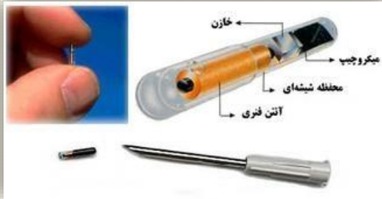
مدار میکروچیپ اسب
